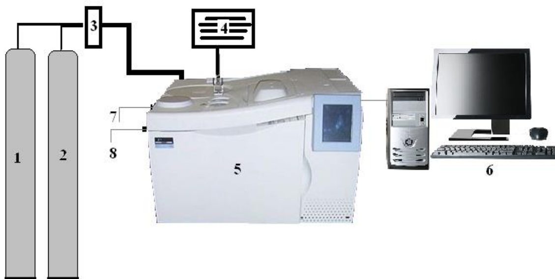
Rysunek 1. Schemat stanowiska pomiarowego służącego do badań chromatograficznych, gdzie 1 – butla z wodorem, 2 – butla z helmem, 3 – układ filtrów do oczyszczania gazu nośnego, 4 – kompresor powietrza, 5 – chromatograf gazowy, 6 – komputer, 7 – rurka do zaworu sześciodrożnego (dozowanie próbki), 8 – rurka do układu odzysku (do regeneracji)
