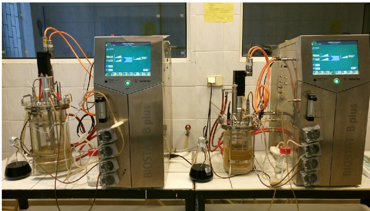
Zdjęcie 1. Stanowisko do badań w skali mikrotechnicznej, fermentory B.Braun
