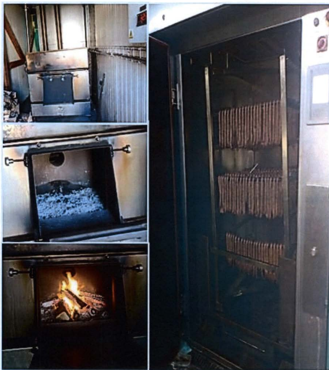
Rys. 2. Palenisko oraz komora wędzarnicza w Zakładzie Mięsnym „Jasiołka”
