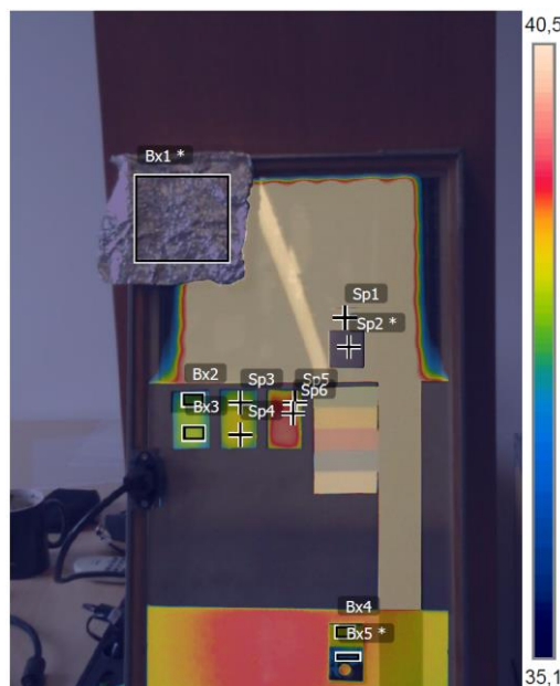
Rysunek 2. Płyta pomiarowa – wyznaczenie współczynnika emisyjności Measuring plate - determination of the emissivity coefficient
