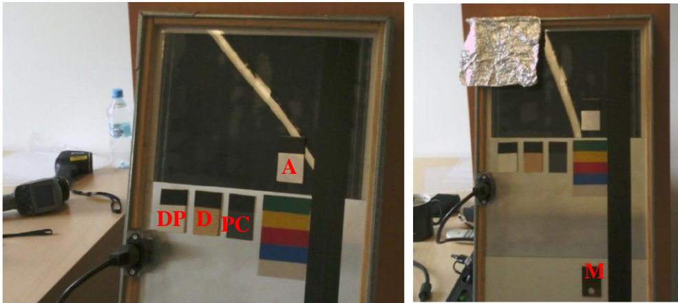
Rysunek 1. Płyta pomiarowa z płytkami, wykonanymi odpowiednio z: aluminium (A), drewno (D), drewno pomalowane (DP), plastik (PCV), miedź (M) Measuring plate with plates, respectively made of: aluminum (A), wood (D), painted wood (DP), plastic (PVC), copper (M)
