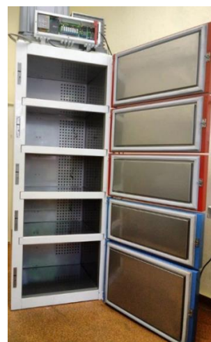
Rysunek 5. Urządzenie MainBox (paczkomat dla żywności) z układami chłodniczymi współpracującymi z automatyką i sterowaniem MainBox device (food parcel locker) with cooling systems cooperating with automation and control
