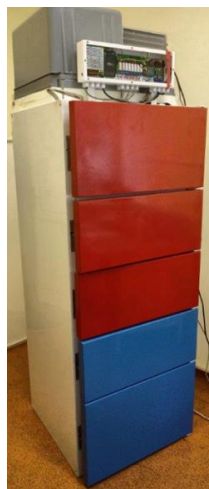
Rysunek 5. Urządzenie MainBox (paczkomat dla żywności) z układami chłodniczymi współpracującymi z automatyką i sterowaniem MainBox device (food parcel locker) with cooling systems cooperating with automation and control
