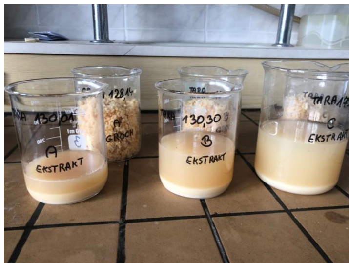
Rys. 1. Przebieg doświadczenia laboratoryjnego optymalizacji wody do procesu ekstrakcji
