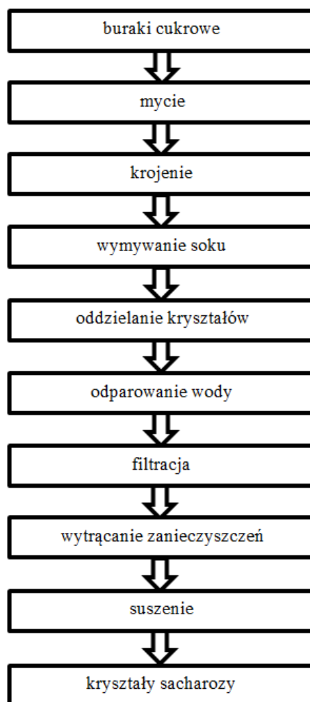
Rys. 3. Schemat etapów jednostkowych w produkcji cukru
