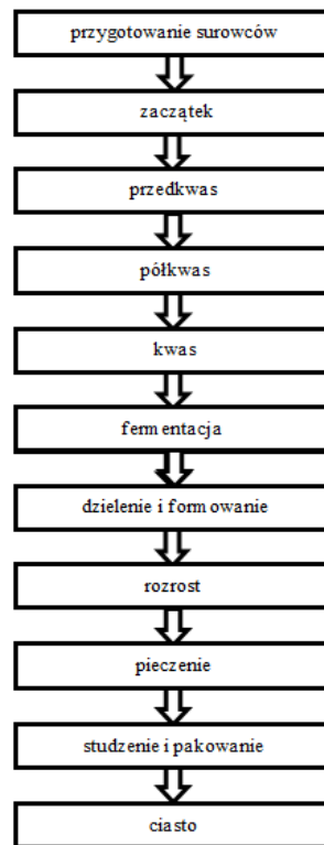
Rys. 6. Schemat ogólny prowadzenia ciasta żytniego
