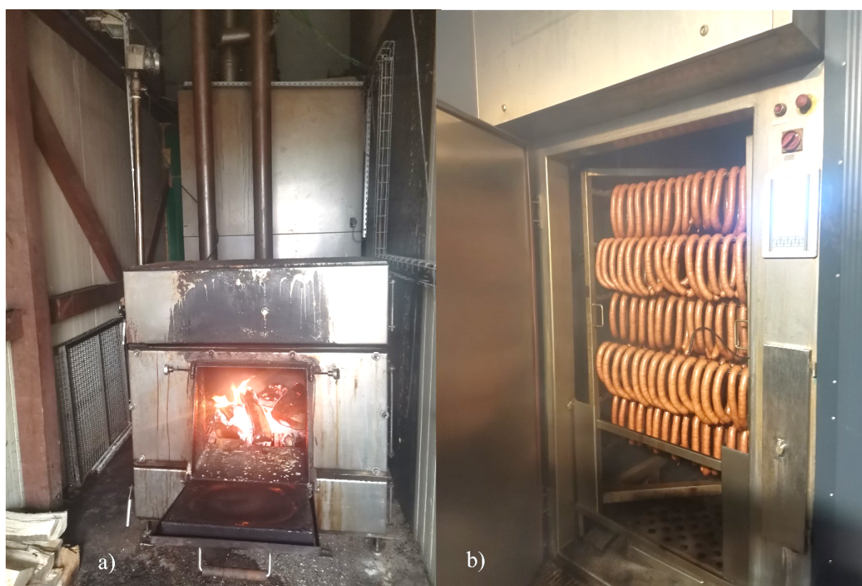
Rys. 27 Wędzarnia innowacyjna w Zakładzie Mięsnym Jasiołka: a) palenisko, b) komora wędzarnicza
